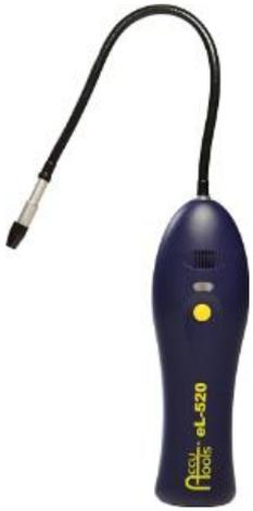
Ce détecteur est utilisé pour isoler rapidement et avec précision les fuites dans tous les systèmes de climatisation et de réfrigération commerciaux, résidentiels, industriels et automobiles. Conforme aux réglementations CE et SAE J1627, il détecte tous les fluides frigorigènes HFC, CFC et HCFC, y compris R134A, R12, R22 ainsi que des mélanges tels que R404A, R408A, R 409A, R 410A et autres.
