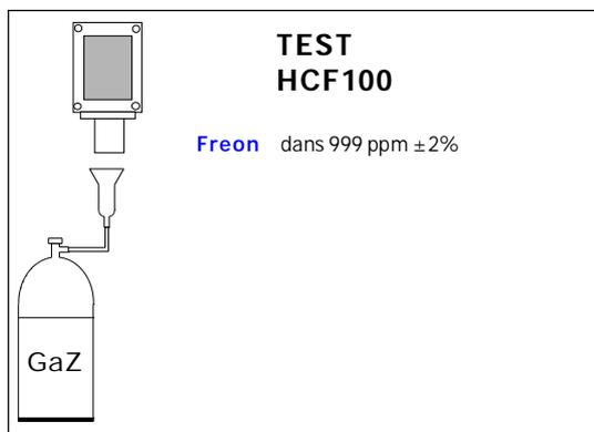
l'installation de la sonde **HCF100**, son entretien ordinaire et extraordinaire, la mise au rebut à la fin de son cycle de vie garantie par le constructeur doivent être effectués par un personnel autorisé et spécialisé.
