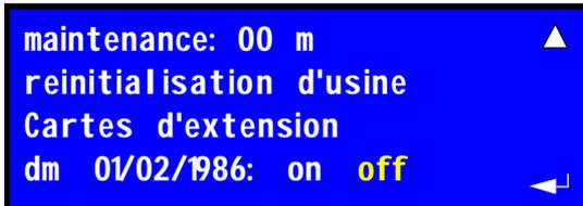
La période d'interruption est gérée directement par le technicien en fonction de la taille de l'installation. Positionnez-vous au-dessus du mot: **"maintenance: 00"** après ... Chaque pression sur **enter** change la durée du temps de **15 - 30 - 45 - 60 minutes maximum**.
