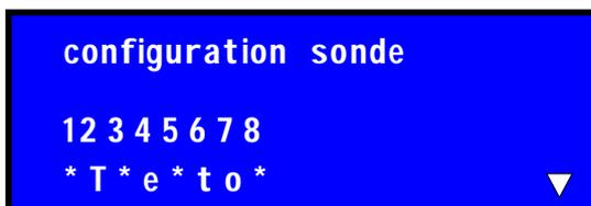
**Activation ou désactivation des sondes et sélection du type gaz: explosif, toxique et oxygène.**
