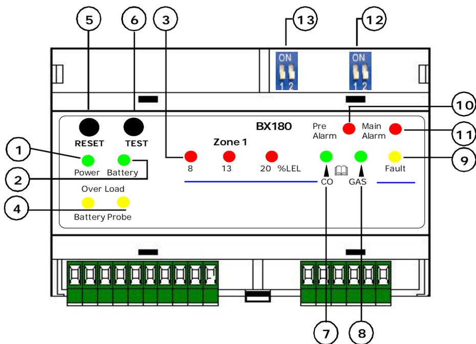
1) **Led de RÉSEAU**, s'allume lorsque la centrale est mise sous tension, initialement ce led clignote pour environ 1 minute et demi en attente de contrôle.
