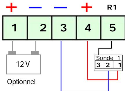
Connexion avec la sécurité positive désactivée et alimentation externe pour la commande de la vanne et de la sirène à 12 V DC
