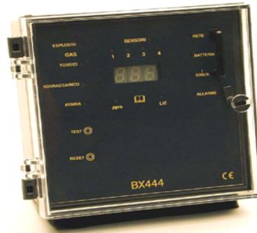
L'unité de contrôle **BX444-Mc** a été étudiée et construite selon les Règles Européennes pour détecter de manière polyvalente, grâce à la possibilité de connecter de **1 à 4** sondes à distance, la présence de **gaz toxiques et/ou explosifs**.
