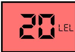
L'afficheur couleur rouge indique une concentration de gaz explosif en % de LEL (L.I.E.) supérieure à une des seuils d'alarme.
